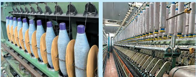
ループラス特有のスラブが糸で発生しがち。糸の欠点が通常糸よりも多いため、捲糸工程では感度設定が難しい。最適条件できれいなチーズまで巻き上げます。
