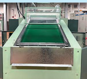
生地の裁断後、素材に合わせて反毛機を過去の実績をもとに設定し最適な条件で反毛ワタまで開織します。
